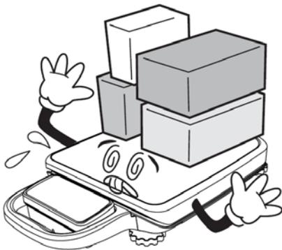
Nepřetěžujte vaši váhu nad její deklarovanou maximální váživost. Při přetížení by mohlo dojít ke zničení snímače zatížení ve váze.
