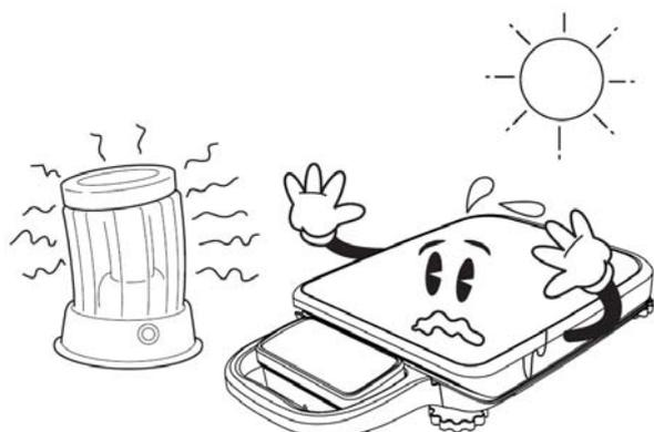
Nevystavujte váhu náhlým změnám teplot ani dlouhodobému přímému působení slunce nebo jiných zdrojů intenzivního tepelného záření. Doporučuje se zapnout váhu 15 až 30 minut před použitím pro důkladnou teplotu váhy.
