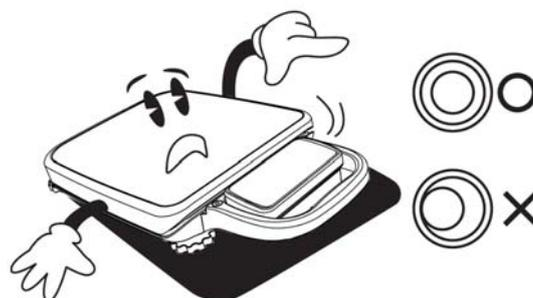
Nevystavujte váhu intenzivnímu proudění vzduchu (například z ventilátoru) ani vibracím – znemožňuje to ustálení váhy a tím dochází i ke snížení přesnosti.
