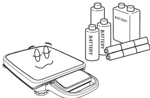
Není-li váha delší dobu používána, uložte ji s plně nabitým akumulátorem a ten případně odpojte. Mohlo by dojít k jeho poškození nebo zničení.
