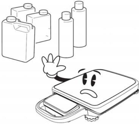
Váha není určena do mokrého nebo chemicky agresivního prostředí. Čištění váhy, zejména klávesnice a displeje, provádějte pouze vlhkým hadrem bez použití agresivních chemických čisticích prostředků – ty mohou nalepat a zničit klávesnici nebo jiné plastové části váhy. Maximální přípustná vlhkost vzduchu je 90%.
