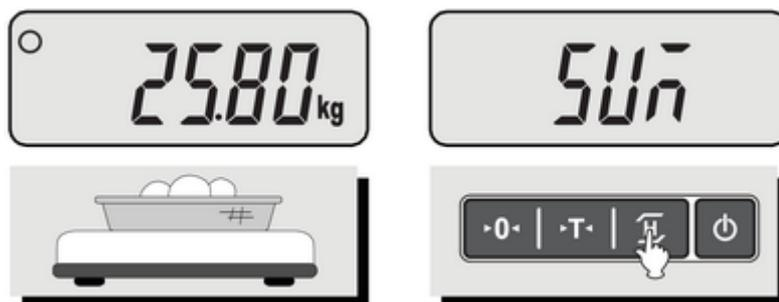
Po sejmutí předchozí navážky vložte na vážicí platformu další navážku (například 19,50kg) a po ustálení opět potvrďte tlačítkem
