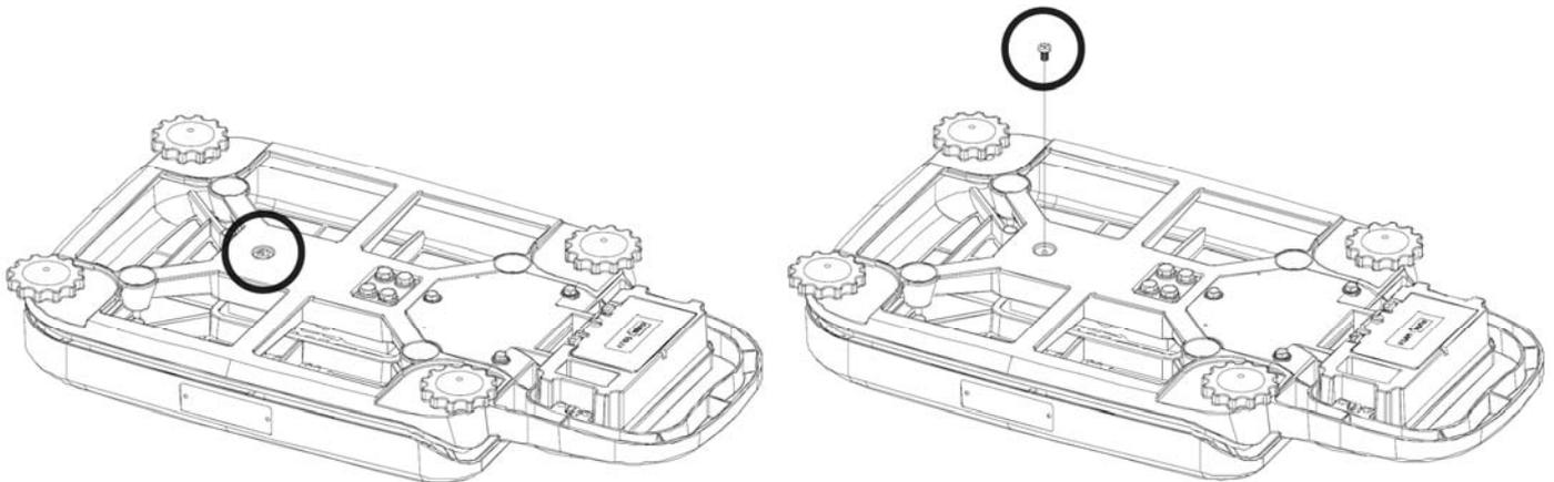
Indikátor je možno vůči vážicí platformě otočit o 180° - pro odečítání údajů z displeje ze strany rukojeti nebo ze strany vážicí platformy.
