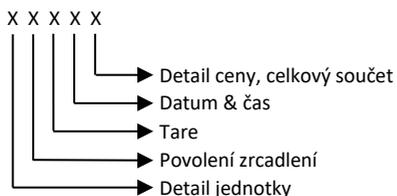
POZNÁMKA: Pokud je váha schváleným modelem; Detail ceny, detail jednotky a tára jsou přenášeny vždy. Pro modely s tiskárnami viz související dokumenty.
