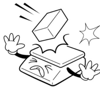
Nepřetěžujte vaši váhu výrazně nad její deklarovanou maximální váživost. Při přetížení více než 20% přes max. váživost by mohlo dojít ke zničení snímače zatížení ve váze.
