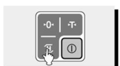
Displej ukáže nápis „**HOLD**“ a váha si chvílkou snímá vzorky hmotnosti, aby mohla v následující chvíli zprůměrovanou hodnotu hmotnosti blikáním zobrazit na displeji (například 0,650kg).
